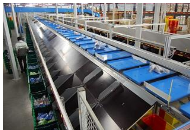
Сортировочная система по принципу поддона с поперечным толкателем
